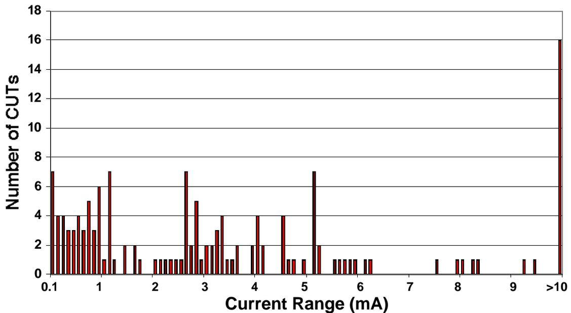
**Figure 6-2 Maximum  $I_{DDQ}$  Distribution of  $I_{DDQ}$  Measurements Larger Than  $100\mu\text{A}$  for IDDQ1 Test Set**
