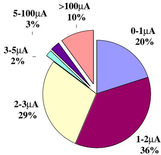
**Figure 6-3 Maximum  $I_{DDQ}$  Distribution of All 1515 CUTs for IDDQ1 Test Set**
